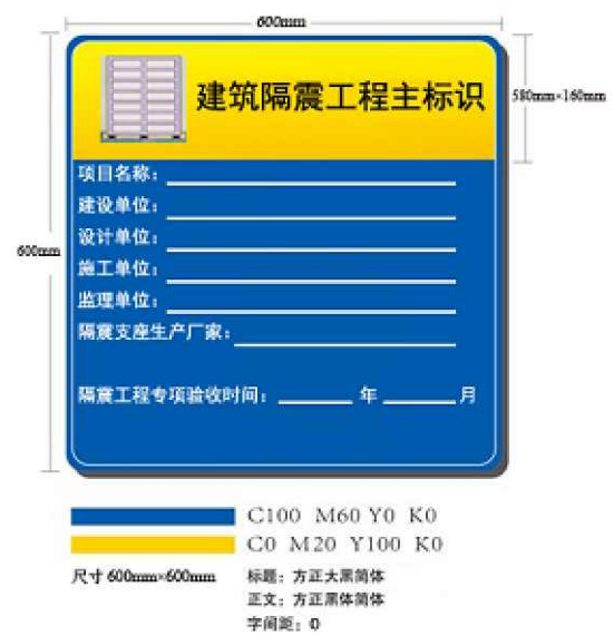
建筑隔震工程主标识
