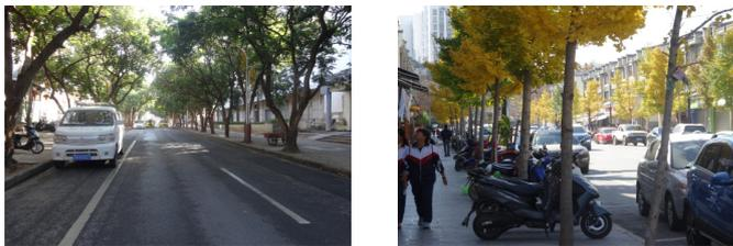
混行车道中机动车道与非机动车道混行，非机动车道以非机动车交通为主，特殊情况下允许机动车借用。
