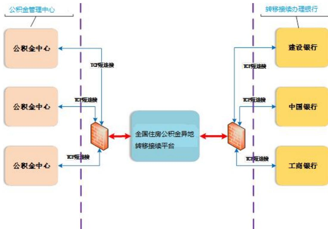
接续平台前置和公积金中心、转移接续办理银行系统采用 TCP 的连接方式。通信安全使用 OpenSSL 的解决方案。交易接口报文采用 XML 报文格式。
