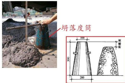
坍落度的测试方法：用一个上口 100mm、下口 200mm、高 300mm 喇叭状的坍落度桶，灌入混凝土分三次填装，每次填装后用捣锤沿桶壁均匀由外向内击 25 下，捣实后，抹平。然后拔起桶，混凝土因自重产生坍落现象，用桶高(300mm)减去坍落后混凝土最高点的高度，称为坍落度。如果差值为 10mm，则坍落度为 10。
