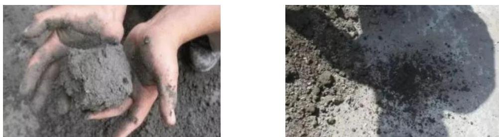
当含水量过大时，应采取翻松、晾干、风干、换土回填、掺入干土或其它吸水性材料等措施，防止出现橡皮土；如土料过干（或砂土、碎石类土）时，则应预先洒水湿润，增加压实遍数或使用较大功率的压实机械等措施。
